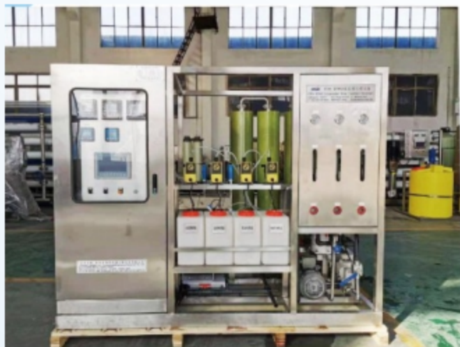
出口日本STRO20吨/天高盐废水处理设备 进水TDS:2万 浓水TDS:6万
