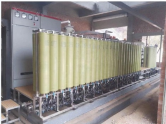
广西DTRO100吨/天双级DTRO垃圾渗滤液处理设备，耐高压，抗污染，自动化程度高
