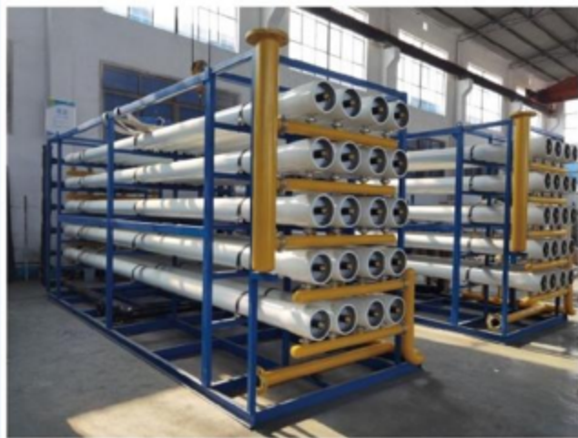
辽宁本溪北营焦化2*120吨/小时反渗透设备
