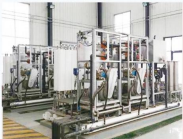
DTRO 垃圾渗滤液处理设备
