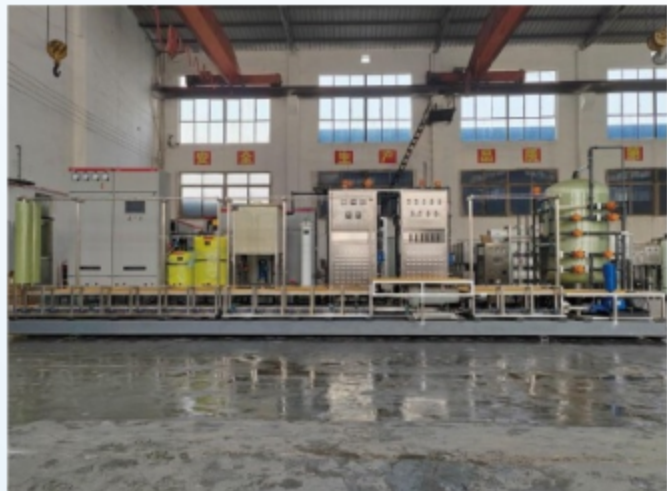
广西DTRO100吨/天双级DTRO垃圾渗滤液处理设备，耐高压，抗污染，自动化程度高
