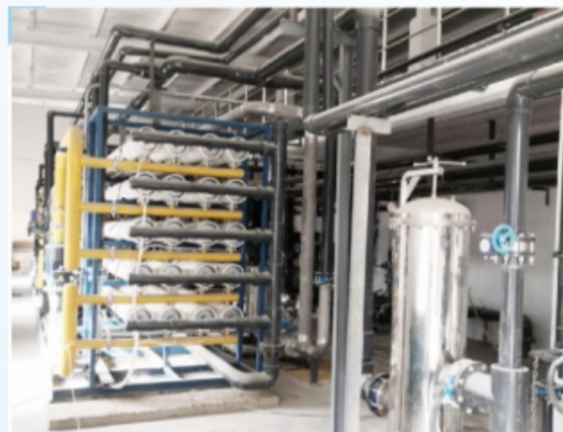
唐山钢铁2*140吨/小时反渗透机组，达到企业用水量与用水质量的标准
