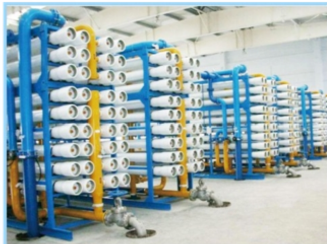
东旭光电100吨/小时电子超纯水 (双级反渗透+EDI+抛光树脂工艺)
